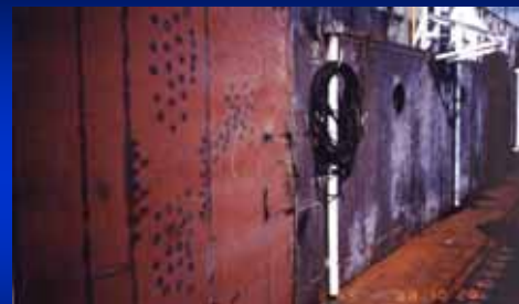
Excelente Resistencia a la Corrosión Blanca (sales de Zinc) Interplate 855 Rojo 1ª. Gen. Silicato Inorg. de Zinc
